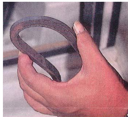
ベルトを裏返して握ると、ひび割れが確認できる。 あったら即、交換だ
