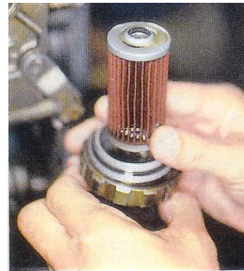
エレメントやエレメントケースが汚れていたらきれいな燃料で掃除。ひどいときはエレメントを交換する
