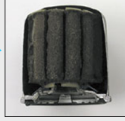
劣化したエンジンオイルフィルタ
