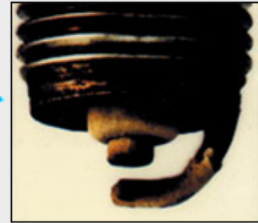
劣化したスパークプラグ
