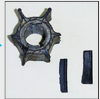
破損したインペラ
