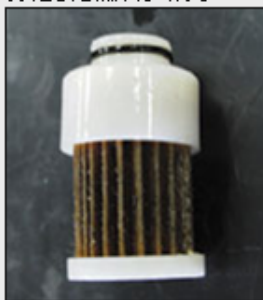
劣化した燃料フィルタ
